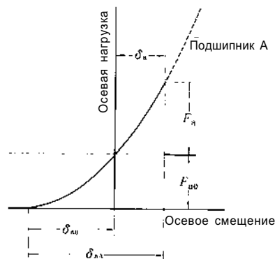
Рис. 10.5 Осевое смещение под действием предварительной нагрузки при постоянном давлении
