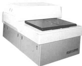
Оборудование для контроля печатных плат VIT-600
